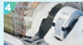
Vytiahni ventilátorový motor
